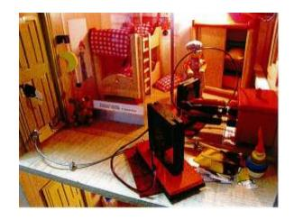
Es lassen sich Effekte der Überdruckbelüftung mit Lüftern außerhalb und innerhalb des Gebäudes darstellen, bei denen im Inneren des Gebäudes ein geringer Überdruck erzeugt wird. Durch geeignete Austrittsöffnungen wird dann die verunreinigte Luft aus den durchströmten Teilen des Gebäudes abgeführt.
